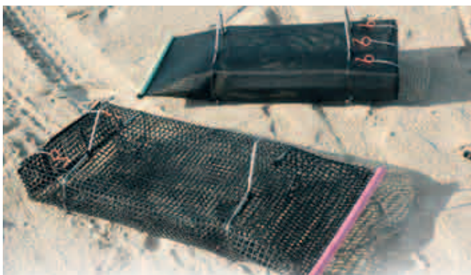
Des zones latérales renforcées supportent les cintres de rigidification. La maille est étudiée pour laisser passer un maximum d'eau.
